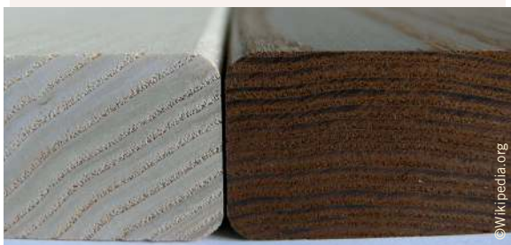
Links unbehandeltes, Rechts thermisch modifiziertes Eschenholz
