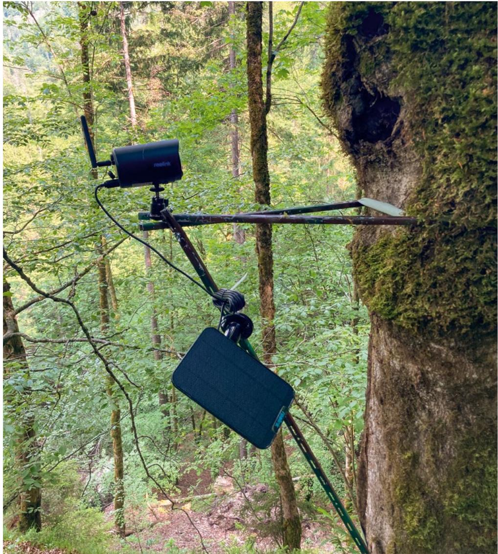
Abbildung 45: Eine der Kamerafallen vor dem Eingang einer Mulmhöhle. Zu sehen ist die Befestigung mit einem Baumstativ und die zusätzliche Stromversorgung mit einem Solarpanel (Foto: capreolus).
